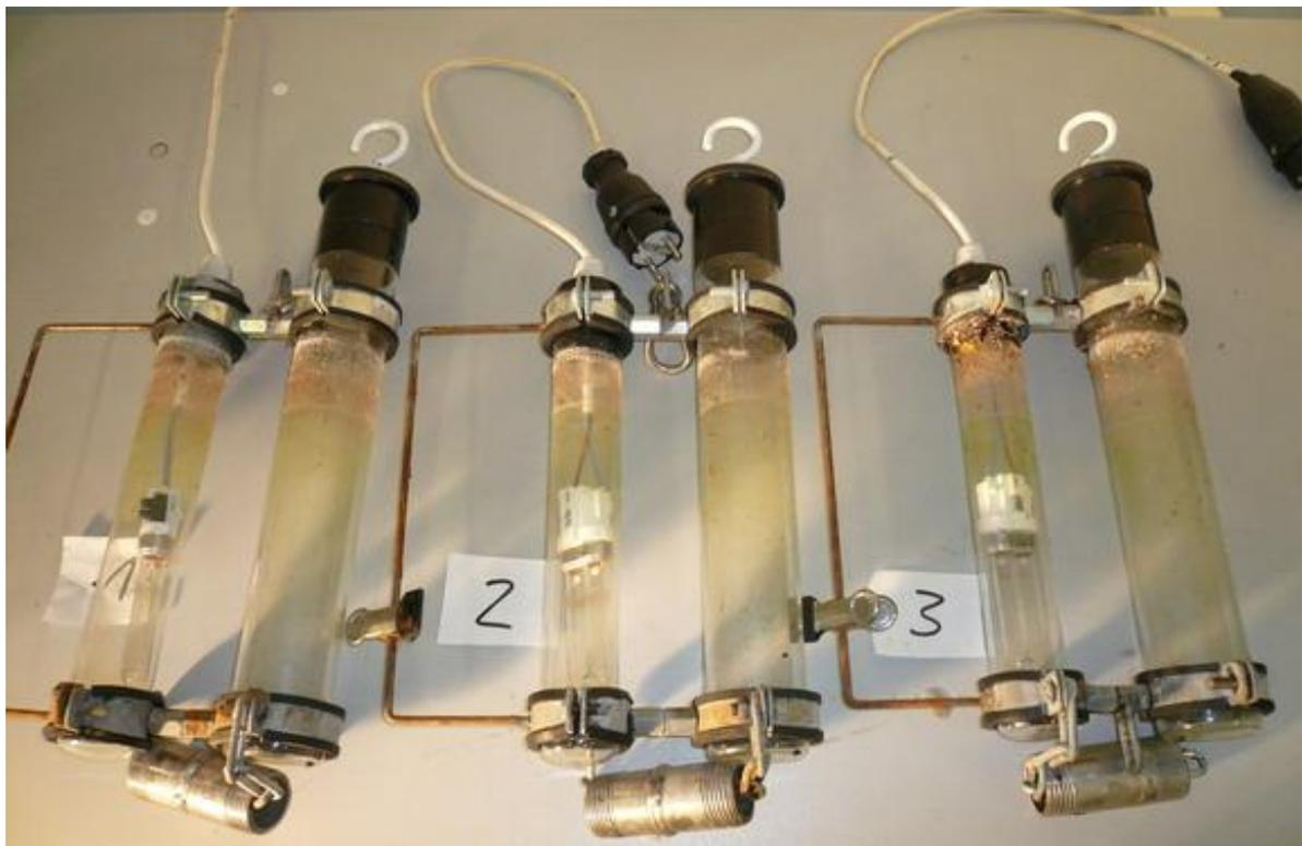
**Abb. 3-12:** *Belagbildung an den Testmustern nach 3 Wochen Anlagenbetrieb (Datum 30.07.2009)*
