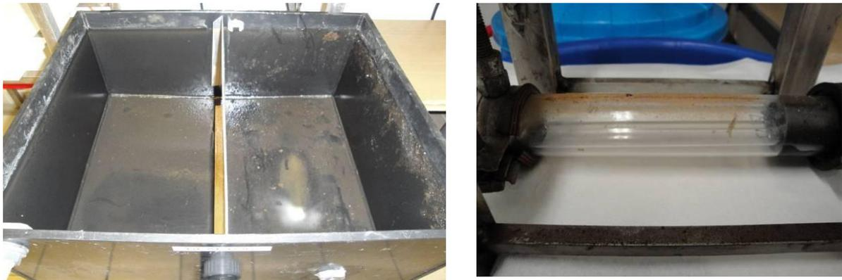
**Abb. 3-23: Verschmutzung des Reaktors (links) und der UVC-Lampe (rechts) am 23.11.2009**
