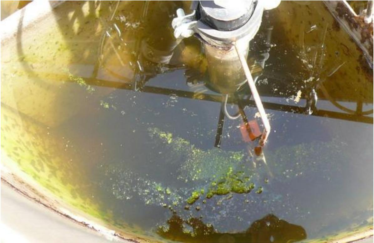
**Abb. 3-8:** *Starkes Algenwachstum und Befall mit Fliegenlarven am 28.07.2009 (Versuchstag 19) geben den Anlass zum Abbruch der Versuchsreihe*
