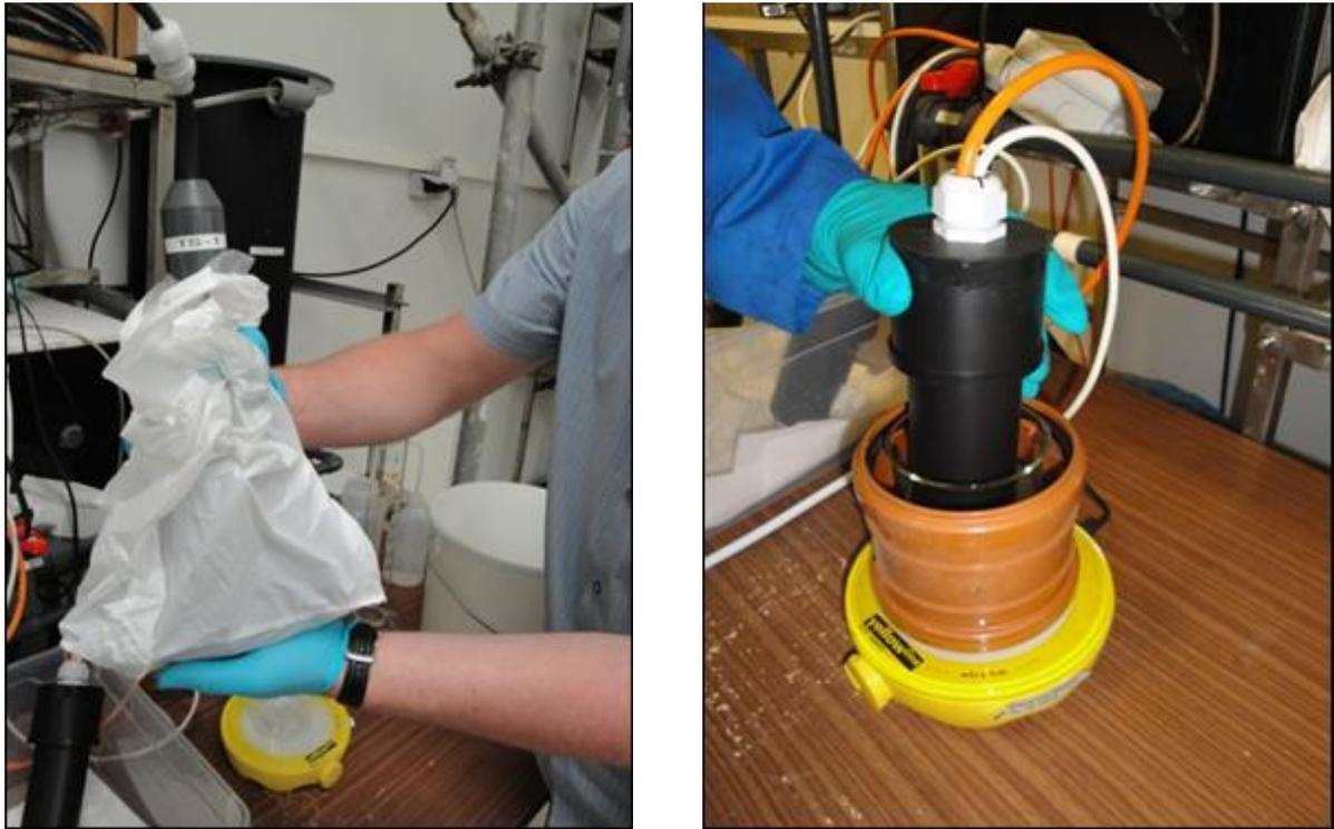
**Abb. 4-10:** Durchführung der Messreihe 10 mit Formazinstandard: mit Plastiktüte für IER-Sonde „Turbisens“ (links) und mit Becherglas für die Testmuster (rechts)
