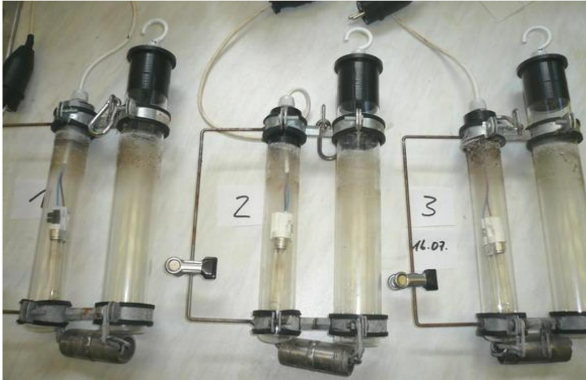
**Abb. 3-11:** *Belagbildung an den Testmustern nach 1 Woche Anlagenbetrieb (Datum 16.07.2009)*
